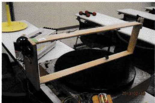
写真2 枠に取り付けた振り子（第2号機）吊り下げた振り子を左の小型モーターで半径方向に引っ張り、撮影記録から振れ角を測る。
