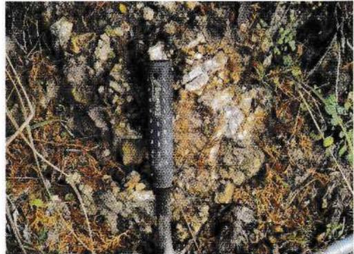
写真10 凝灰角礫岩 (角礫多量)
