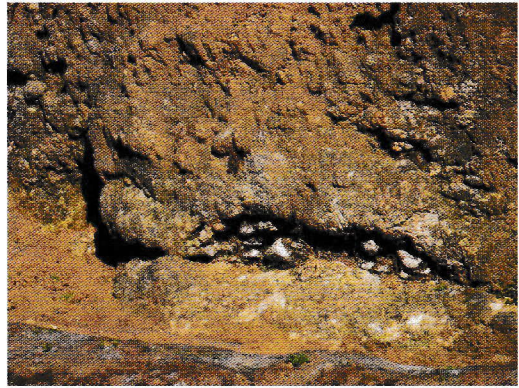
写真7 ジャガイモ畑の強風化凝灰角礫岩
