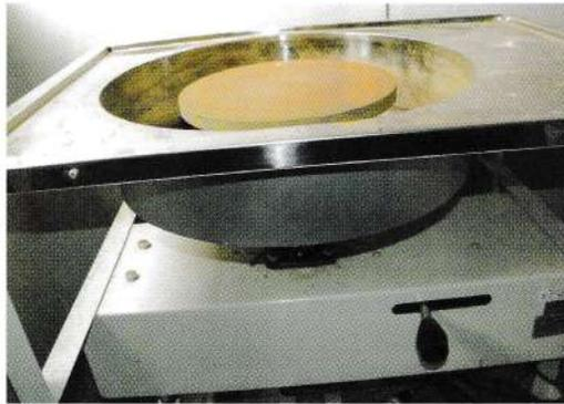
图8 岩石研磨機（耐水研磨紙）
