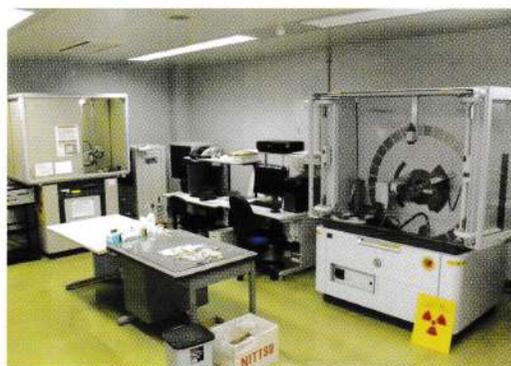
図5 粉末X線回折装置
