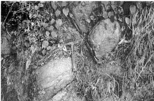
5 風化帯に残留する玉石（玉ねぎ状風化の芯） の露出状態。（名切地区）
