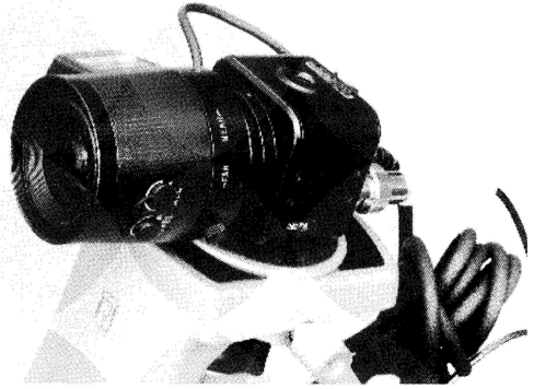
写真2. 高感度ビデオカメラの近景 6mmレンズとの組み合わせで、画角は 68.5^\circ 。 たいへん小さく軽い上に高感度なカメラで、Cマウ ントになっており、掩蔽観測など流星以外への用途 もいろいろと考えられる。
